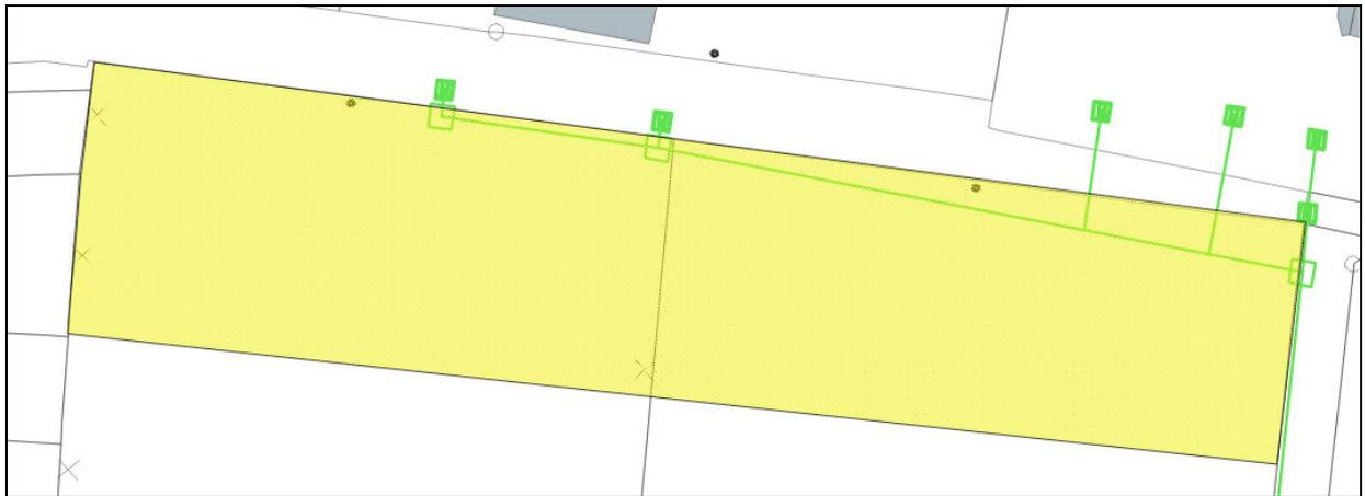
La superficie de la zone 1 AU étant de 0,5ha, le volume de retenue utile à prévoir est d'environ 60 m<sup>3</sup> au total avec un débit de fuite de 1,5 l/s.
