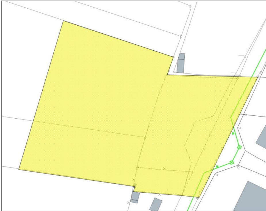
La superficie aménagée des zones 1 AU et 1AUx étant de 2,2 ha, le volume de retenue utile à prévoir est d'environ 440 m<sup>3</sup> au total avec un débit de fuite de 11 l/s.
