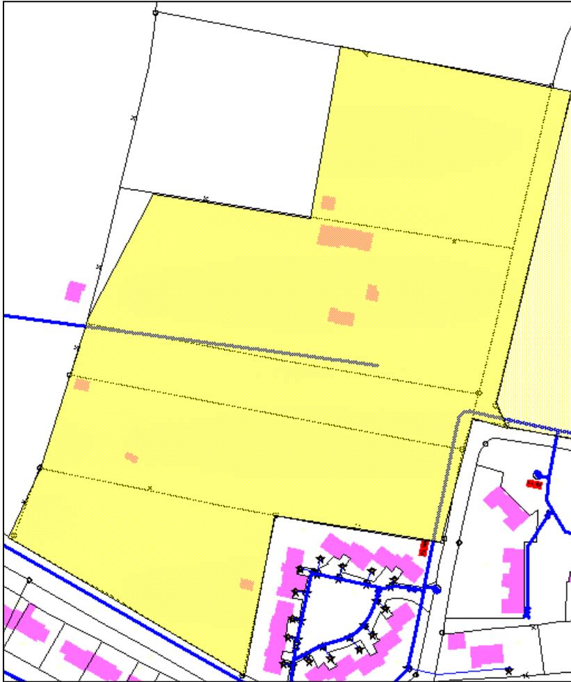
La desserte de la ZAC est déjà en partie assurée par la canalisation PVC 75 mm qui traverse la zone en frange sud et en partie ouest. Les 2 raccordements simultanés permettraient d'obtenir un réseau de type maillé sur l'ensemble de la zone.
